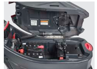
Tanque de recuperación con empuñadura para inclinarlo fácilmente
